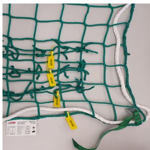
Abb. 16 Prüffäden (Prüfmaschen) am Netz
