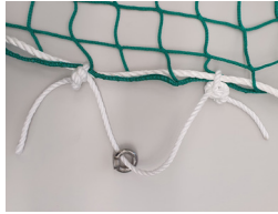
Abb. 5 Zweisträngiges Aufhängeseil Bruchkraft R_k \geq 15 \text{ kN}
